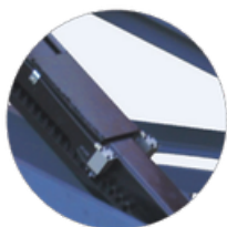
Cerradura mecánica: dientes laterales dobles, liberación neumática
